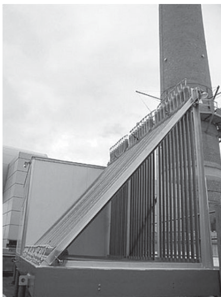
Рис. 2. Биореактор GreenFuel на испытаниях в Мичиганском технологическом институте (2004 год). Мощность электростанции 20 МВт. Высота биореактора 2,5 м. Трубки для выращивания водорослей диаметром 10–20 см. Длинная сторона треугольника ориентируется на солнце. Выхлопные газы электростанции закачиваются в биореактор, создавая циркуляцию воды и водорослей в треугольнике. «Созревшие» водоросли выпадают в осадок на дне треугольника. Захватывается до 86 % оксидов азота.
