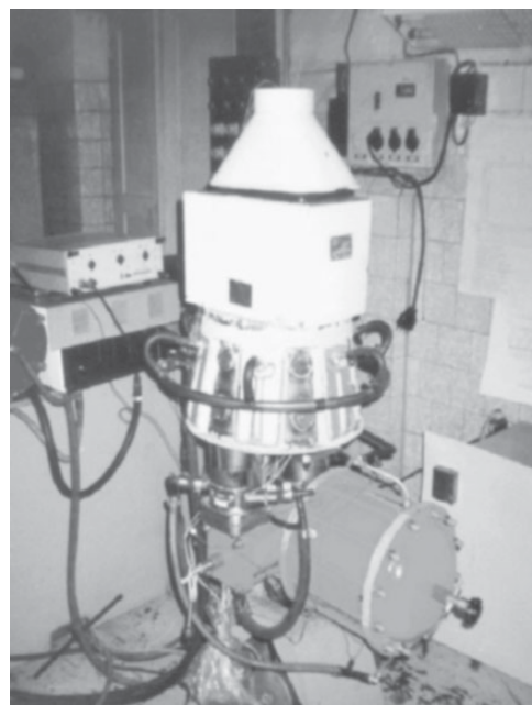
Рис. 4. Установка комбинированного электротеплоснабжения на базе двигателя Стирлинга мощностью 3 кВт
