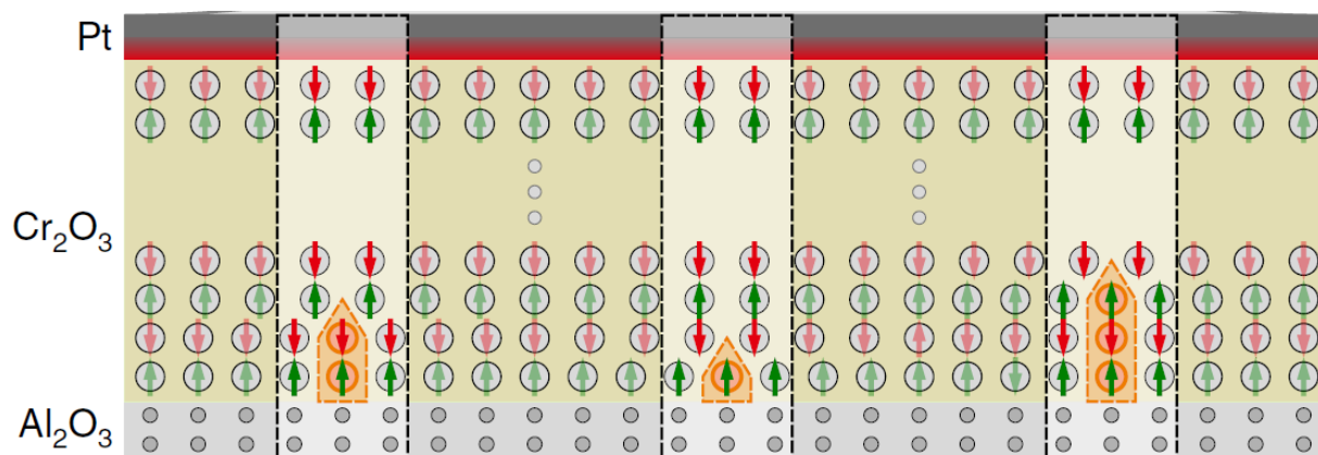
Рис. 1 Элемент магнитоэлектрической памяти произвольного доступа: Pt – электрод из платины, \text{Cr}_2\text{O}_3 – магнитоэлектрический слой, \text{Al}_2\text{O}_3 – подложка.
