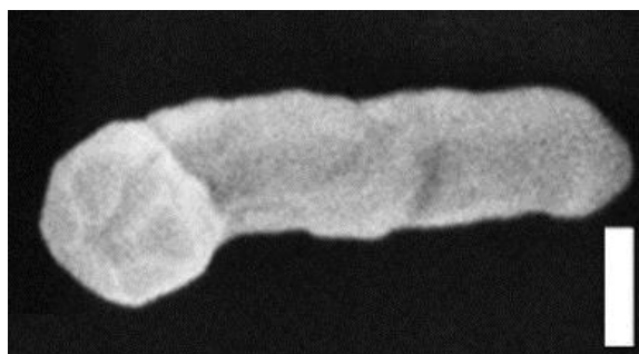
Электронное изображение нанонити X (длина вертикального отрезка 100 нм)
