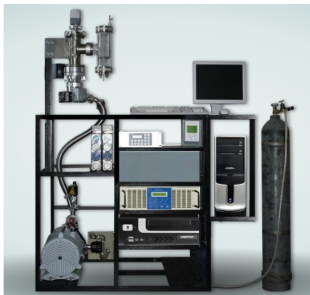
Рисунок 1 – Внешний вид лабораторной вакуумной установки модульного типа
