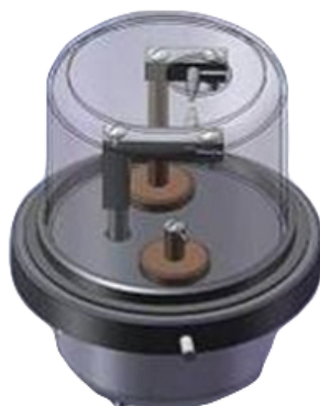
Рисунок 16 – Внешний вид модуля дугового испарения
