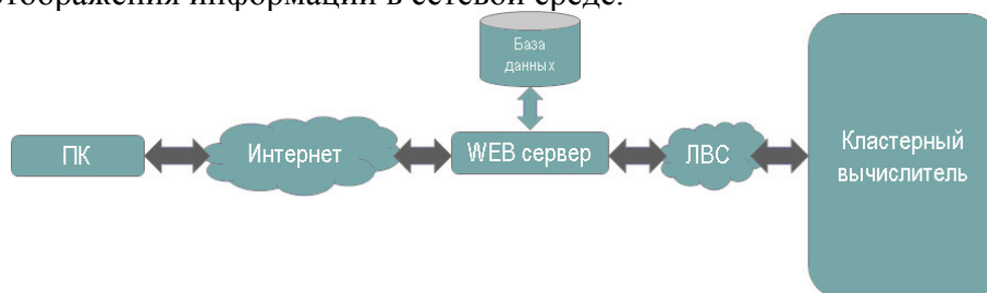
Рисунок 5 Схема системы удаленного доступа
