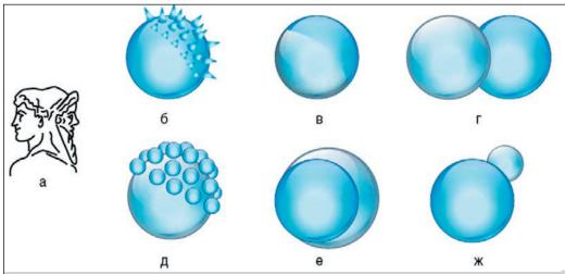
Схематическое изображение бифункциональных частиц: (а) -двуликий Янус, (б) - частица-янус, (в) - частица, состоящая из двух разных половинок, (д) - частица, одна из полусфер которых напоминает малину, (г), (е), (ж) - частицы в форме гантели, желудя и снеговика, соответственно.
