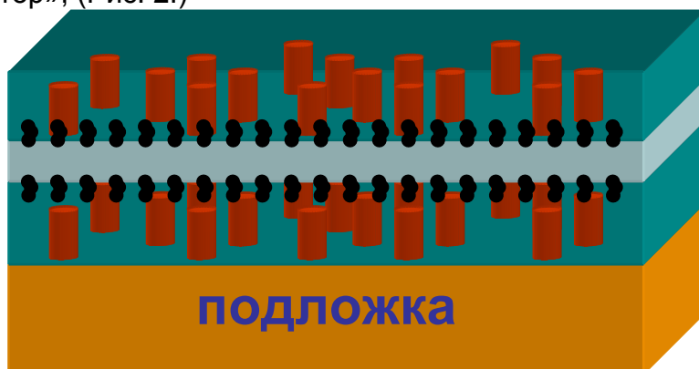
Рис.2 Модель сложного композитного тонкопленочного материала. Сверхпроводящий слой с колончатыми включениями (красный цвет) переслаивается со слоем изолятора, на пересечении «сверхпроводник/ изолятор» схематично изображены дефекты (черный цвет)
