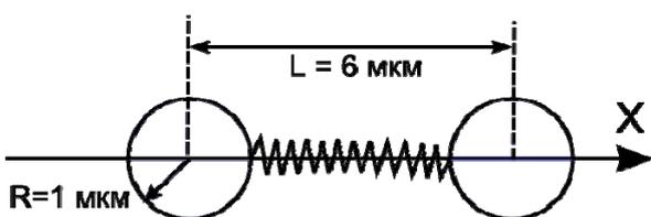
Целью эксперимента является обнаружение тепловых флуктуаций молекулы. В ходе эксперимента были измерены авто- и кросс-корреляционные функции смещения микросфер, определенные соответственно как:
