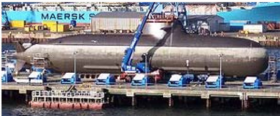
Подводная лодка класса U212 (Германия) с силовой установкой на водородных топливных элементах.
