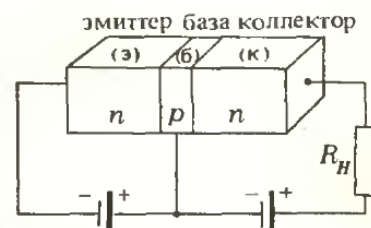
Рис. 2. Схематическое изображение биполярного транзистора.
