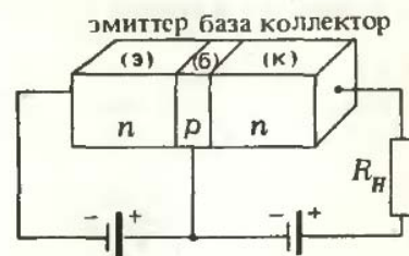
Рис. 1. Схематическое изображение биполярного транзистора.
