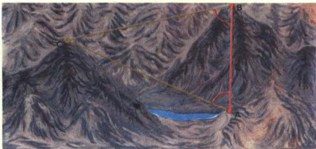
Рис. 3. Метод триангуляции. Зная длину AB и углы \alpha и \beta , можно определить расстояние до объекта C .
