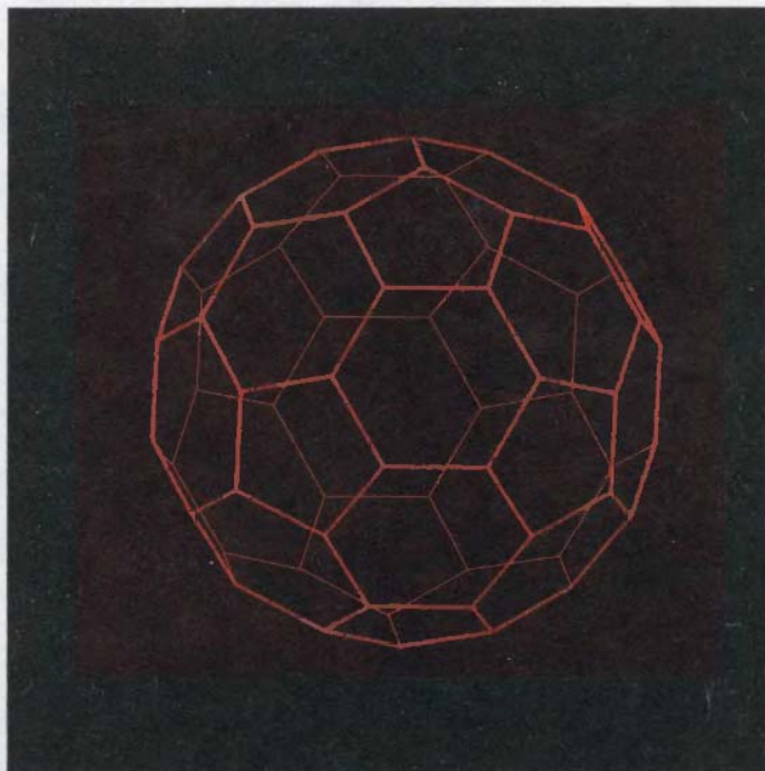
ПРОСТРАНСТВЕННАЯ СТРУКТУРА БАКМИНСТЕРФУЛЛЕРЕНА C_{60} (ФУТБОЛИНО). В ВЕРШИНАХ МНОГОГРАННИКА НАХОДЯТСЯ АТОМЫ УГЛЕРОДА.
