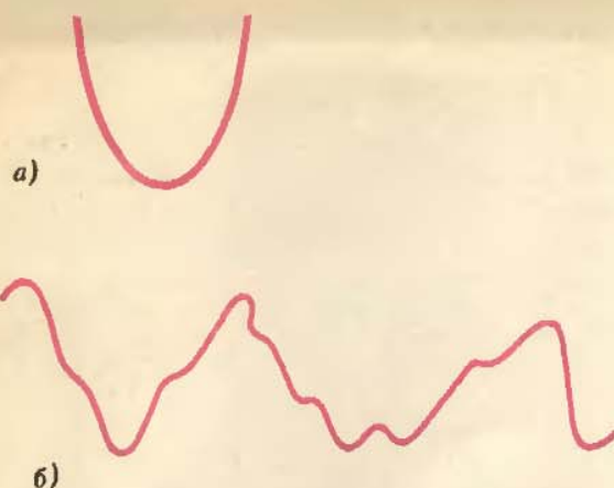
Рис. 4. Рельеф потенциальной энергии: а) в упорядоченных магнетиках, б) в спиновом стекле.
