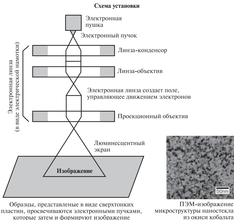
Рис. 6. Принцип работы просвечивающего электронного микроскопа
