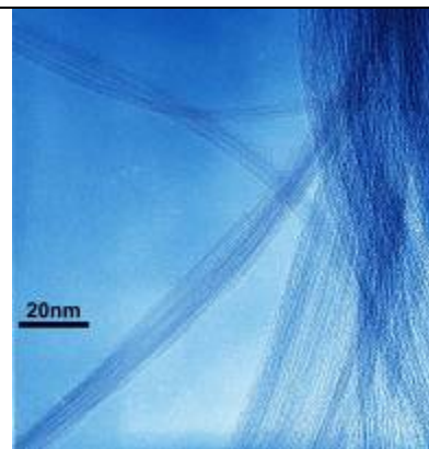
Одностенные углеродные нанотрубки (а также ОУНТ, заполненные неорганическими соединениями и НТ в аморфной оболочке), 5-10 нм в диаметре
