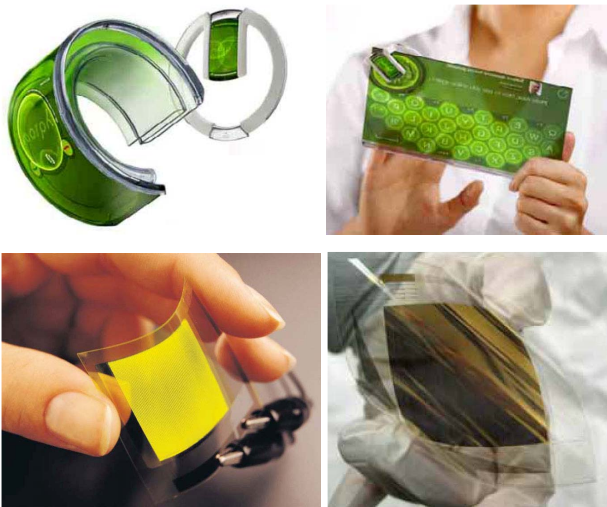
Рис. 1. Примеры устройств гибкой электроники: концепт сотового телефона фирмы Nokia (а, б), гибкий дисплей с органическим светодиодом (в), тонкопленочный транзистор, полученный с помощью метода струйной печати на гибкой пластиковой подложке (г).
