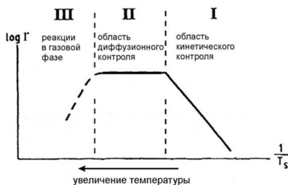
Рис.4-9 (a). Кинетика CVD-осаждения пленок в Аррениусовских координатах «логарифм скорости осаждения – обратная температура».
