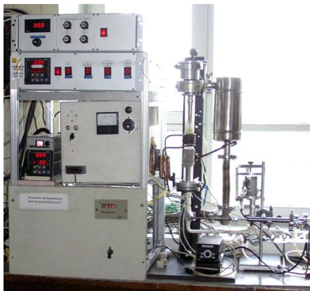
Рис. 4-12. Установка MOCVD с порошковым сбросовым источником
