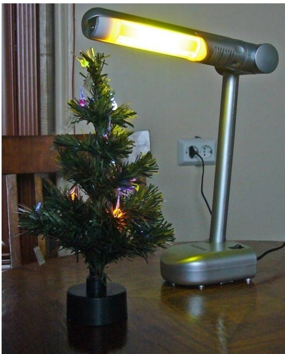
Рис.15. Лампа и новогодняя елочка с разноцветными гирляндами, использующими люминесценцию монодисперсных квантовых точек (Р.Б.Васильев, ФНМ МГУ)
