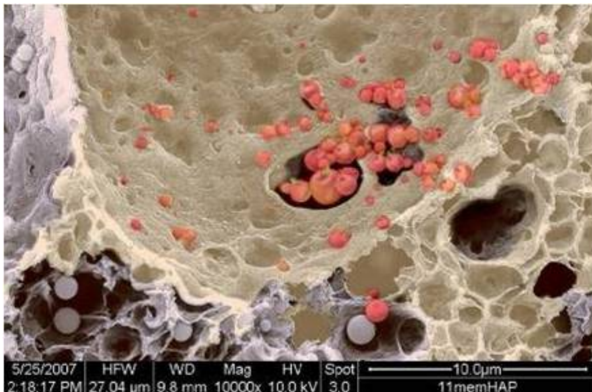
Рис. 21. Искусственная кость из чешуек гидроксилапатита. (сканирующая электронная микроскопия, фото с сайта www.nanometer.ru , Е.Ковалева, А.Г.Вересов, В.И.Путляев, химический факультет, ФНМ МГУ)
