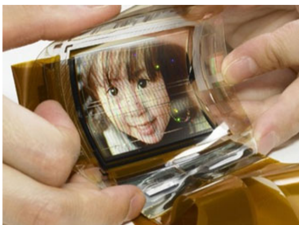
Рис. 2-22. Прототип гибкого дисплея, созданного на основе технологии ОЭЛУ (SONY).
