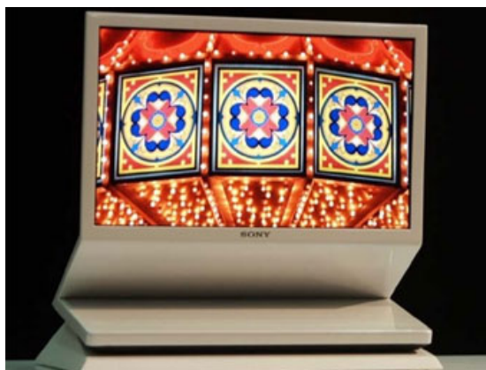
Рис. 2-21. Телевизионные панели, созданные компанией SONY по технологии ОЭЛУ.
