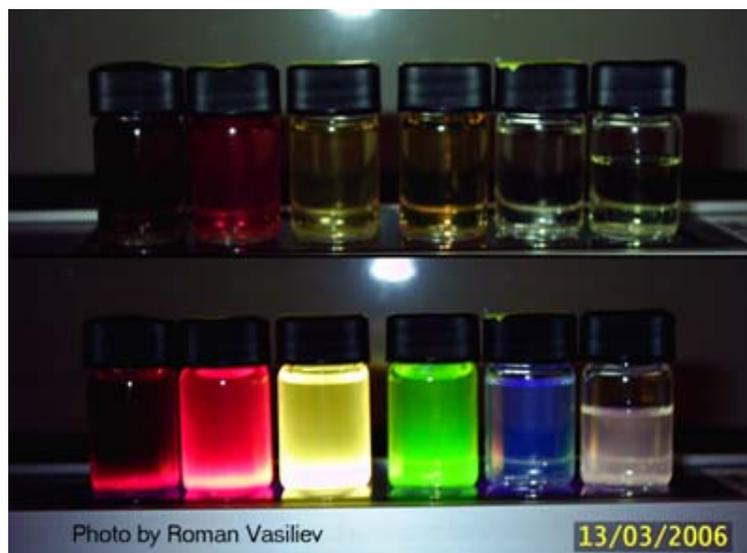
*Рис.2 Люминесценция образцов квантовых точек CdSe с размером в диапазоне 2.0-5.5 нм, приготовленных в виде золей. Вверху – без подсветки, внизу – подсветка ультрафиолетовым излучением. Фото автора.*
