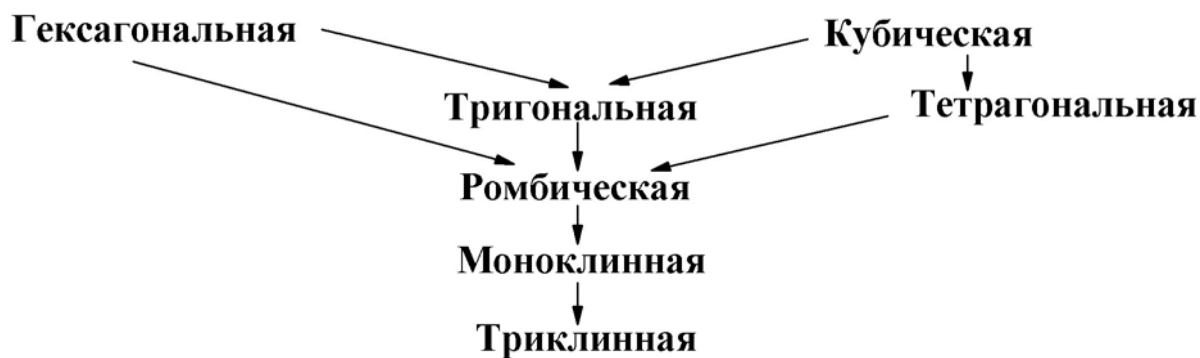
Рис.61. Симметрия кристаллов. а. решетки Бравэ: триклинная: a \neq b \neq c , \alpha \neq \beta \neq \gamma , моноклинная: a \neq b \neq c , \alpha = \gamma = 90^\circ , \beta > 90^\circ , ромбическая: a \neq b \neq c , \alpha = \beta = \gamma = 90^\circ , тетрагональная: a = b \neq c , \alpha = \beta = \gamma = 90^\circ , гексагональная: a = b \neq c , \alpha = \beta = 90^\circ , \gamma = 120^\circ , кубическая: a = b = c , \alpha = \beta = \gamma = 90^\circ . б. Схема подчинения сингоний
