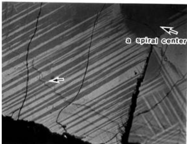
Рис.54. Рост в районе двойникового дефекта (двугранного угла). а. схема роста, б. зигзагообразный фронт роста, декорирующий направление двойникового (границы темных и светлых полос).
