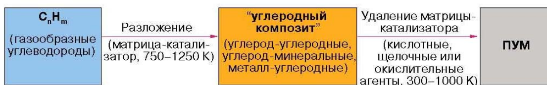
Рис. 4 Получение ПУМ каталитическим разложением углеводородов
