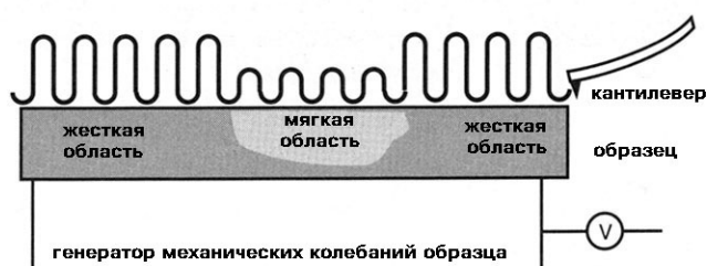
Рисунок 0-3 Амплитуда колебаний кантилевера изменяется в зависимости от механических свойств поверхности образца.
