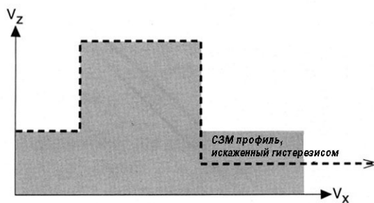
Рисунок 2-5 Влияние гистерезиса на измеренный профиль ступеньки.
