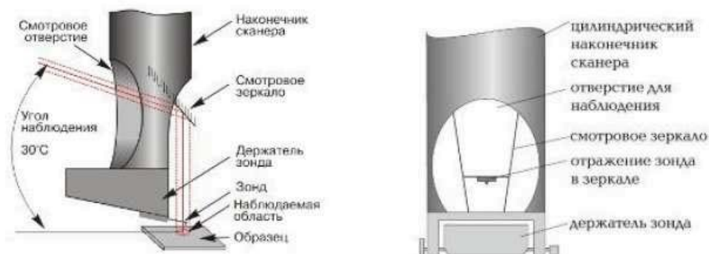
Рис.2.7. Система зеркал для визуального наблюдения кантилевера и образца
