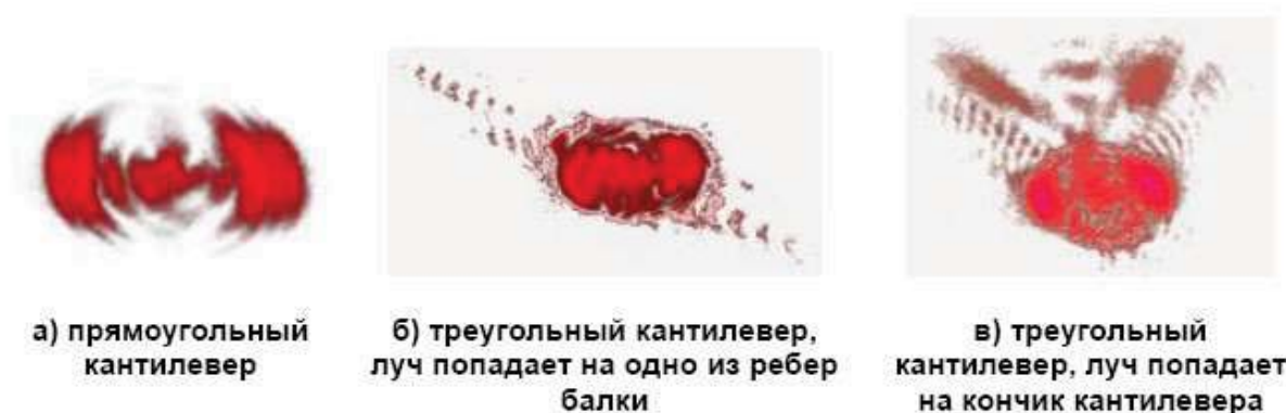
Рис.2.11. Интерференционные картины, возникающие при наведении лазера на конец кантилевера
