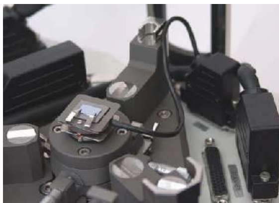
Рис.2.3. Установка термостолика
