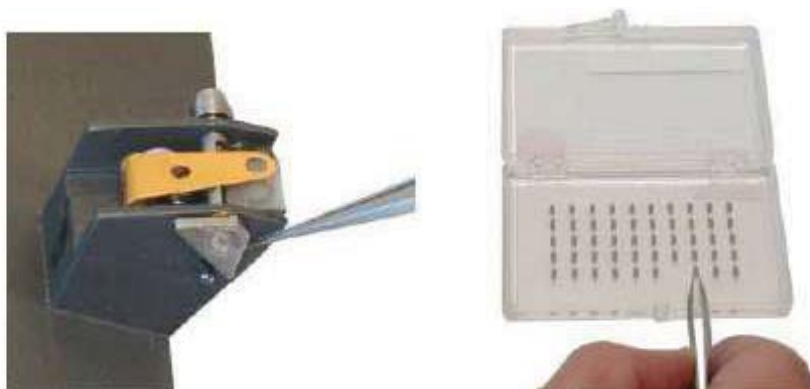
Рис.2.4. Установка кантилевера
