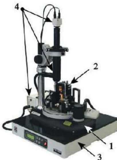
Рис.2.1. Основные блоки и системы NTEGRA: 1 – базовый блок; 2 – измерительная головка; 3 – система виброизоляции; 4 – система видеонаблюдения
