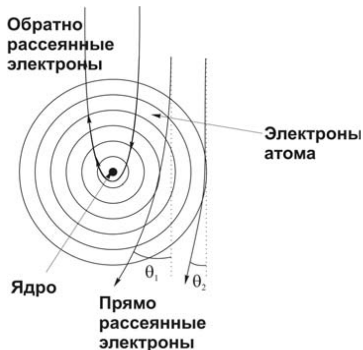
Рис. 1.2. Два механизма упругого взаимодействия электрона с изолированным атомом. Кулоновское взаимодействие с электронной оболочкой атома отклоняет электрон на малые углы, а взаимодействие с ядром приводит к отклонению на большие углы вплоть до обратного рассеяния.
