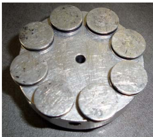
Рис. 3.4. Держатель, на столики которого закрепляются образцы.
