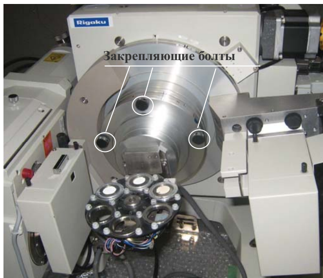
Рис. 11. Гониометр с приставкой для 6ти образцов.
