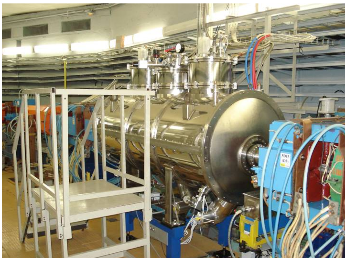
Рис. 16. Сверхпроводящий вигглер, установленный на накопительном кольце КИСИ.
