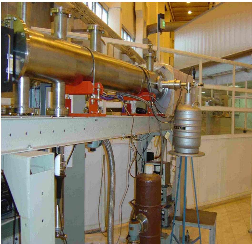
Рис. 21. Вакуумируемая камера малоуглового рассеяния.
