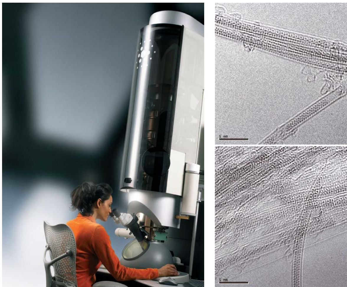
Рис. 7. Электронный микроскоп FEI Titan 80-300 и изображение одностенных углеродных нанотрубок, заполненных одномерным нанокристаллом CuI. На незаполненных трубках различимы отдельные атомы углерода.
