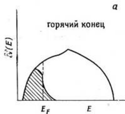
Зонная структура на границе металл — полупроводник, приводящая к возникновению э. д. с. Пельтье.
