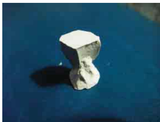
Образец биоцемента после механических испытаний
