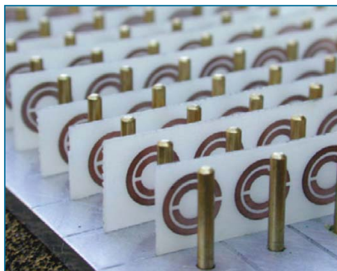
Рис. 1. Фотография метаматериала с отрицательным показателем преломления для микроволнового излучения
