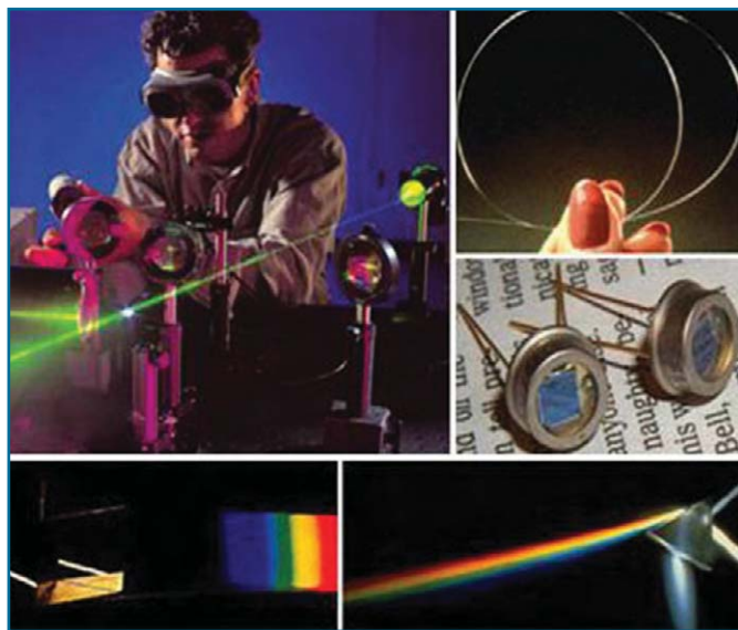
Рис. 1. Некоторые элементы фотоники: лазер, стеклянное оптоволокно, фотодиоды, призма и дифракционная решетка
