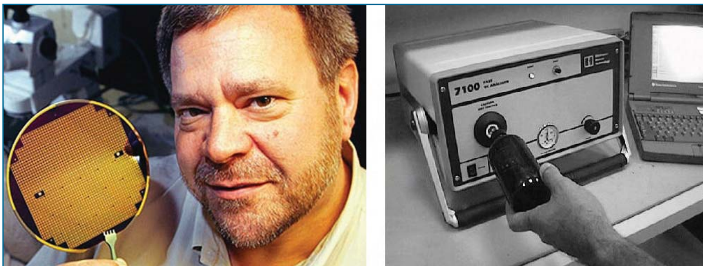
Рис. 1. Чип-пластина «электронного носа» из 2200 ячеек-анализаторов Sensation, университет Беркли, США (слева). Быстрый газовый хроматограф GC/SAW лабораторного типа (справа)
