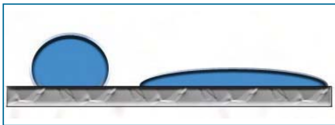
Рис. 1. Капля воды (слева) и ПАВ (справа) на тефлоновой поверхности
