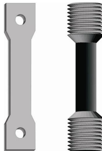
*Вид деталей для механических испытаний.*
