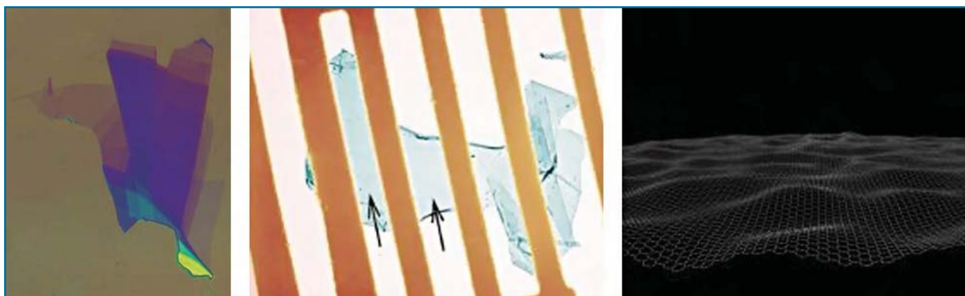
Рис.2. Пленки графена, полученные на окисленной кремниевой подложке и на золотом каркасе. Модель искаженной графеновой пленки толщиной в один атом.
