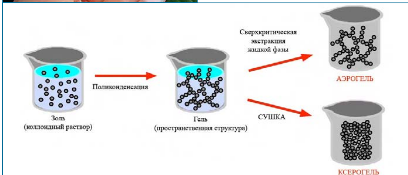
Рис. 1. Схематичное представление золь-гель процесса
