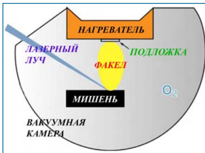
Рис. 1. Схема метода лазерной абляции для нанесения тонких пленок
