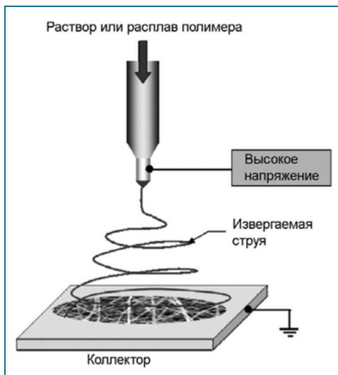
Рис. 1. Схематическое представление процесса электроспиннинга
