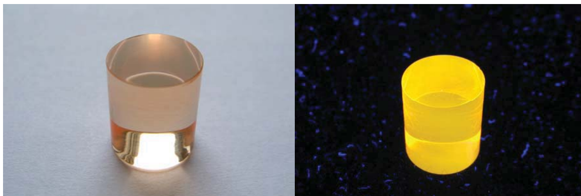
Рисунок 11. Композит КТ CdSe/CdS – ПММА при дневном свете (слева) и с подсветкой УФ-излучением (справа)
