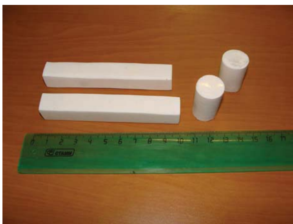
Рис. 1. Внешний вид образцов из оксида алюминия для механических испытаний.
