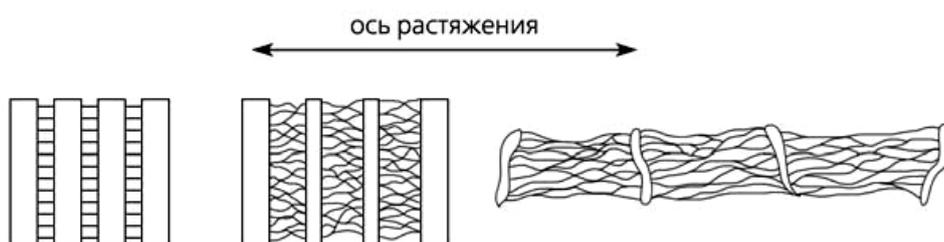
*Рис.5. Схема, иллюстрирующая коллапс структуры полимера, происходящий при больших значениях деформации в адсорбционно-активной жидкости, на различных стадиях растяжения.*
