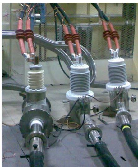
Рис. 2. Два типа токовых вводов, присоединенные к электрической и криогенной системам полигона.
