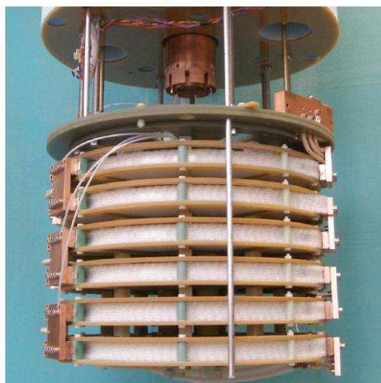
Рис. 1. ВТСП токоограничивающий модуль Siemens (425 А, 8,4 кВ).
