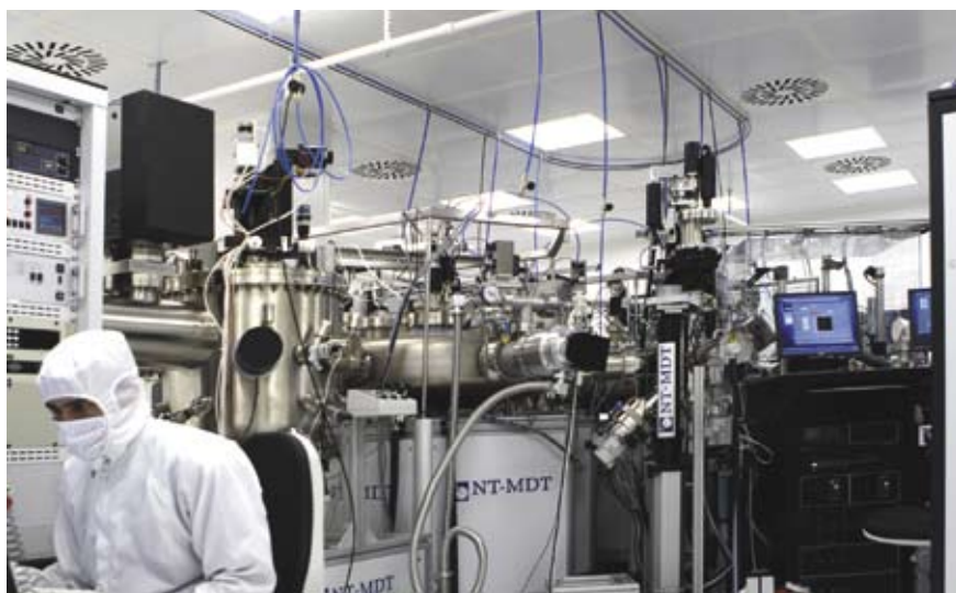
➤ Многофункциональный сверхвысоковакуумный нанотехнологический комплекс НАНФАБ 100 (установлен в ТТИ ЮФУ)
