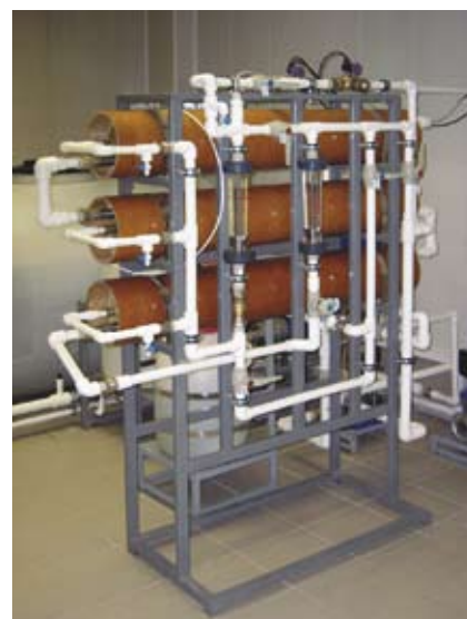
► Установка очистки воды методом обратного осмоса
