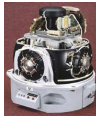
➤ Общий вид гиросtabilизатора с гравиметрическим датчиком
