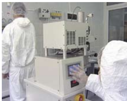
➤ Рис. 2. Наностановка фирмы ULVAC для выращивания углеродных нанотрубок
