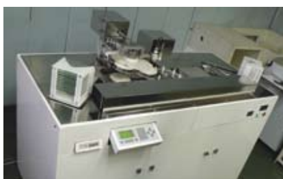
► Установка отмывки фотошаблонов
