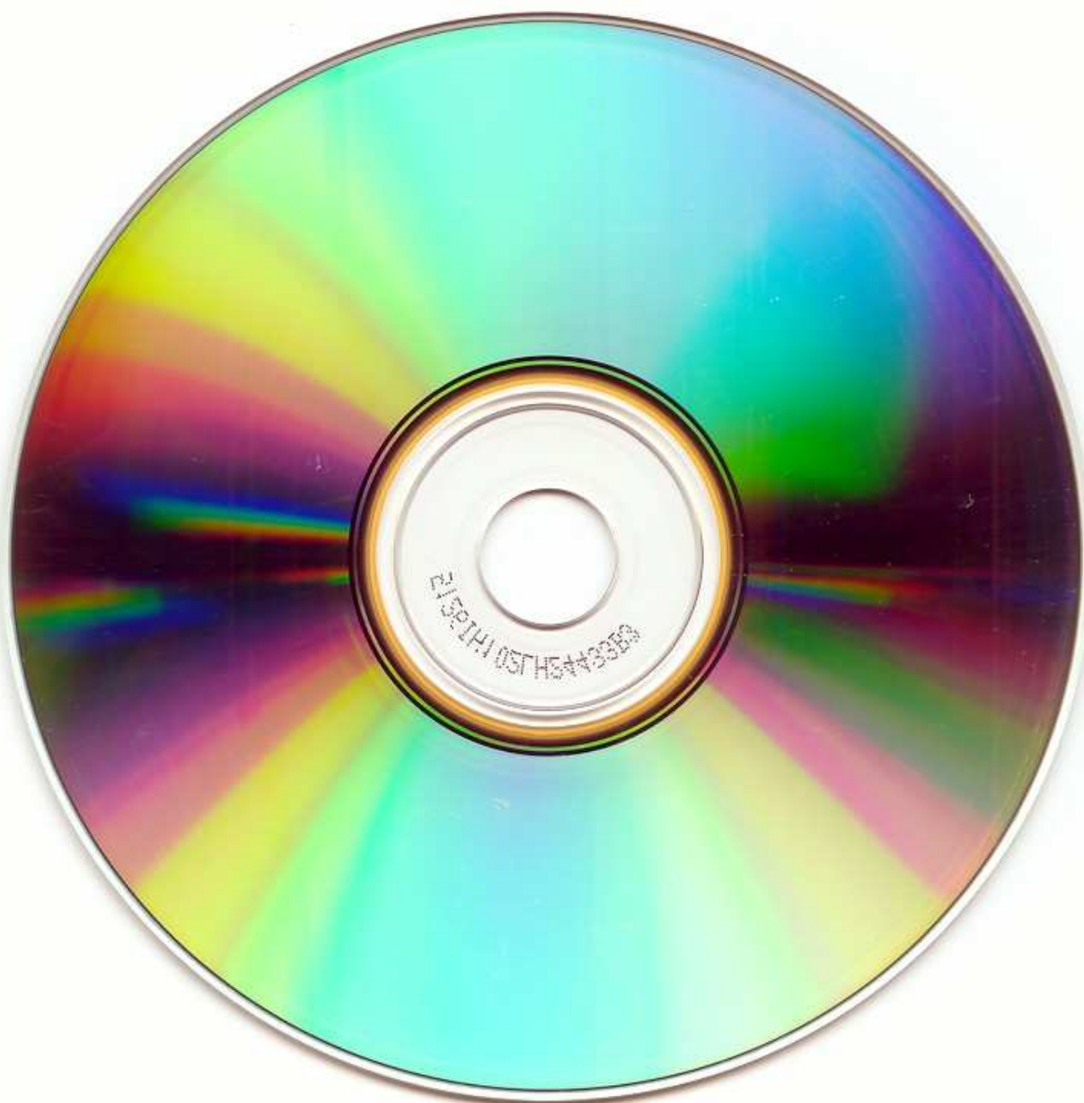
Рис. 2. CD-Rom. Ниже приведены стандартные размеры дисков. Внешний диаметр диска - 120 \pm 0.3 мм, Диаметр внутреннего отверстия - 15 \pm 0.1 мм. Зона, где непосредственно записана информация, называется программной зоной. Внутренний диаметр программной зоны имеет диаметр 50 мм. Внешний диаметр программной зоны имеет диаметр 116 мм. Перед программной зоной находится вводная зона, минимальный диаметр которой равен 46 мм. В этой зоне записывается информация о содержимом диска. За программной зоной находится выводная зона, ширина которой равна 1 мм. Прижимная зона используется для фиксирования компакт-диска в приводе. Ее внутренний диаметр равен 26 мм, а внешний - 33 мм.
