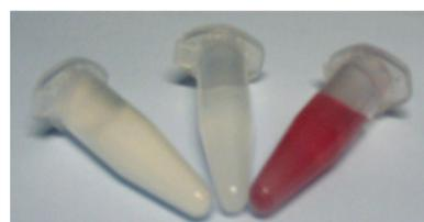
Управление оптическими свойствами суспензий мультислойных оболочек (радиус 2 микрометра, толщина 10 нм): «молоко», «вода» и «красное вино».
