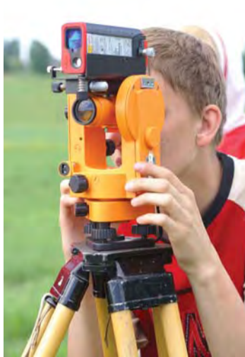
Топографическая практика: теодолит 4Т30П с лазерным дальномером
