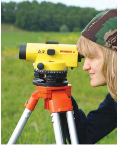
Топографическая практика: нивелир Runner (производство Leica, Швейцария)
