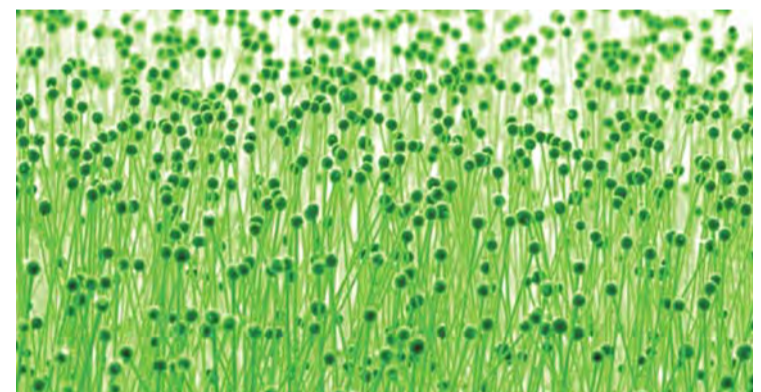
Наношнуры оксида цинка, синтез которых катализирует германий (Ge — шарики на кончиках)
