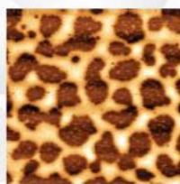
Блоксополимер стирол– Бутадиен–стирол на слюде 5x5 мкм
