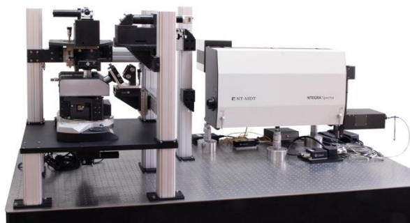
Рис. 3. Комбайн СЗМ, Рамановской и люминесцентной спектроскопии ИНТЕГРА-СПЕКТРА-2 [3].
