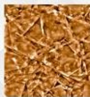
Материал графлекс Видны обрывки листов графита 11x11 мкм
