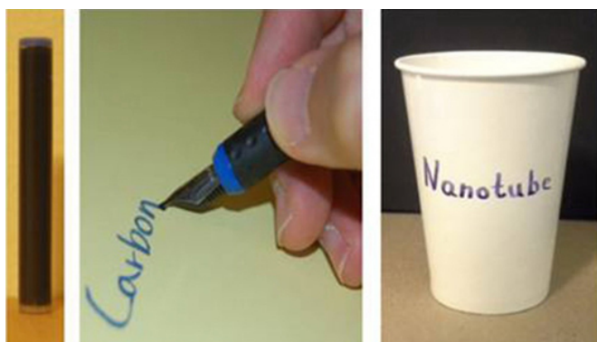
Рис. 1. Картридж для перьевой ручки с чернилами на основе углеродных нанотрубок (слева), слово “Carbon”, написанное на обыкновенной бумаге с помощью перьевой ручки (в центре), слово “Nanotube”, написанное на бумажном стаканчике (справа).
