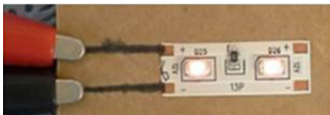
Рис. 2. Электрическая цепь, построенная из светодиодов и чернил на основе углеродных нанотрубок.
